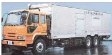
ガスタービン移動発電機車
